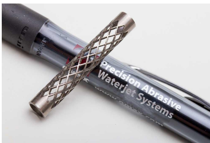
Obr. 5 Implantát pro opravy kostí vyrobený metodou mikro AWJ s rotační osou [8].
