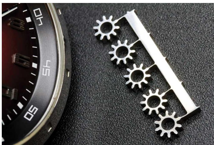
Obr. 4 Příklad výroby komponentů do hodinových strojků metodou mikro AWJ [8].
