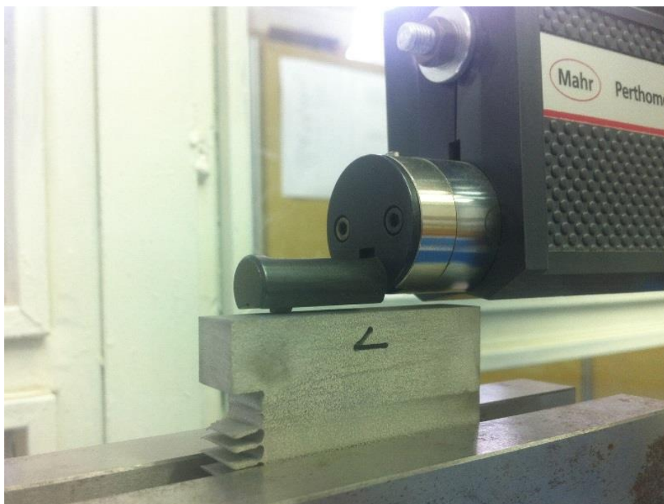
Obr. 17 Měření vzorku 12 mm na kontaktním měřicím přístroji Mahr.
