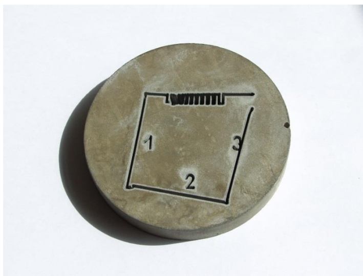
Obr. 10 Příklad důsledku nedostatečného upevnění polotovaru.
