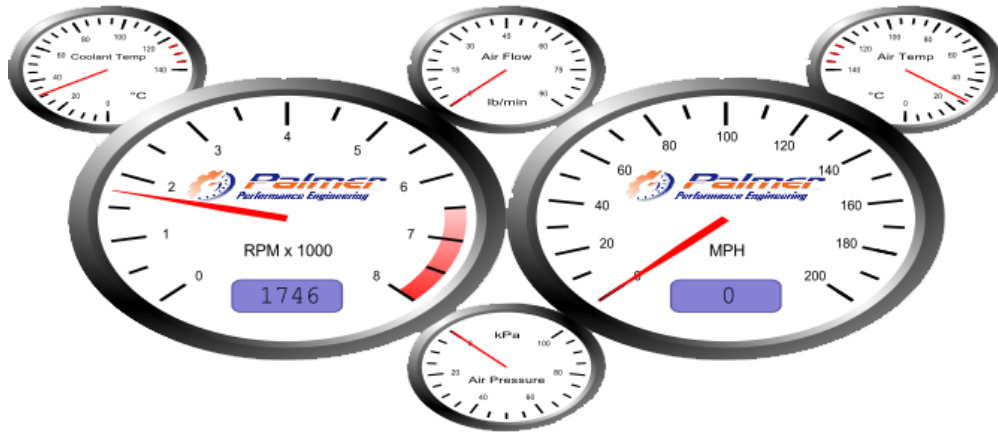
Obr. č. 5.5 Zobrazení hodnot čidel v grafickém rozhraní programu ScanXL
