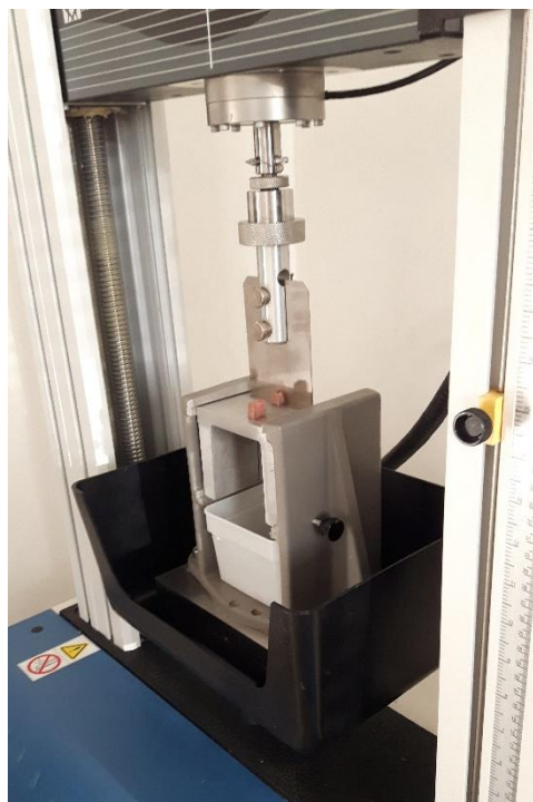
Obrázek 4: Měření síly stříhu na přístroji Instron
