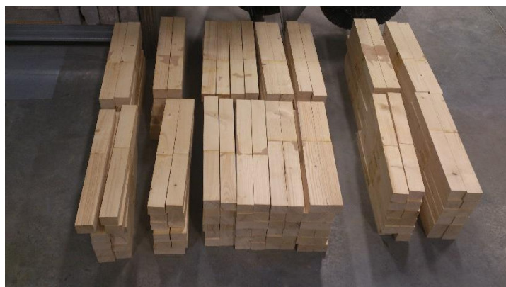
Obr. č. 17: Sada zkušebních vzorků (1 typ lepidla) před teplotním zatěžováním
