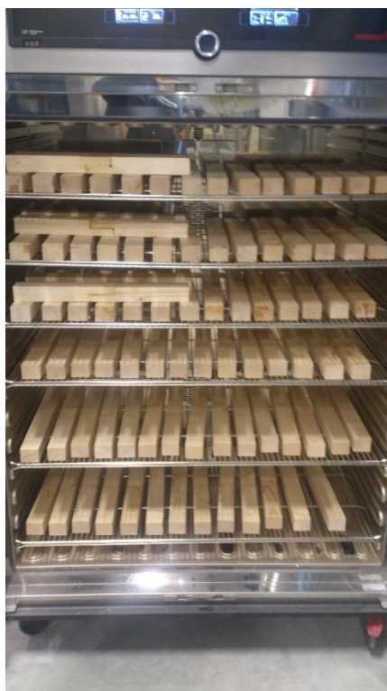
Obr. č. 18: Sada zkušebních vzorků (1 typ lepidla) umístěných v horkovzdušné sušárně
