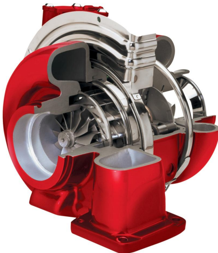
Obr. 3.6 Turbodmychadlo Holset s proměnnou šířkou statoru turbíny [33]
