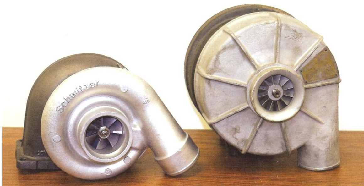
Obr. 1.2 Moderní Schwitzer-BorgWarner S3 a starý model Schwitzer [1]
