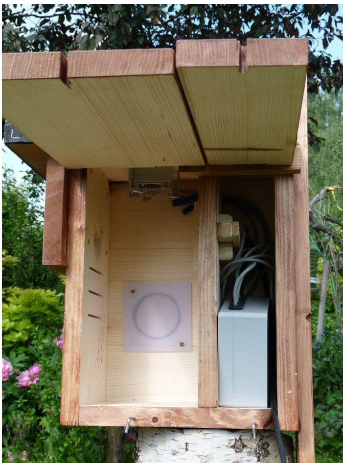
Obr. 19. Vybavení chytré ptačí budky (foto: M. Zárybnická)
