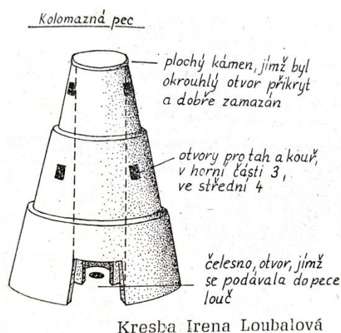
Obr. č. 7: Konstrukce kolomazné pece (Zdroj: 4)
