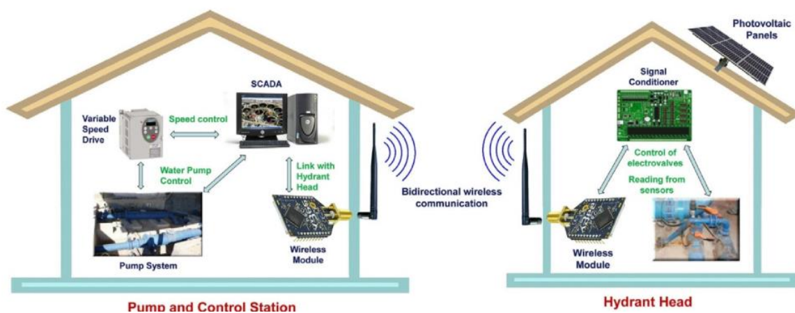
Obr. 8: Bezdrátový plně automatizovaný závlahový systém na GH
