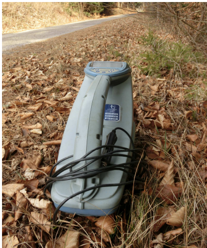
Obr. 6.04 Indukční navázání signálu vnitřní cívkou
