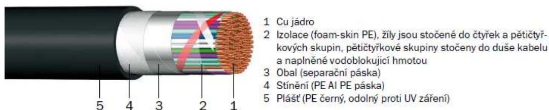
Obr. 3.10 Sdělovací kabel konstrukce TCEPKPFLE [16]
