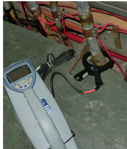
Obr. 6.05 Indukční navázání signálu klešťovou cívkou
