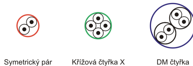
Obr. 3.8 Typy symetrických prvků [5]
