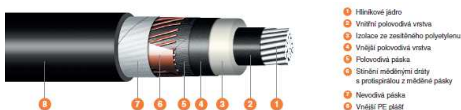
Obr. 3.5 Kabel vn (10-AXEKCE) [11]
