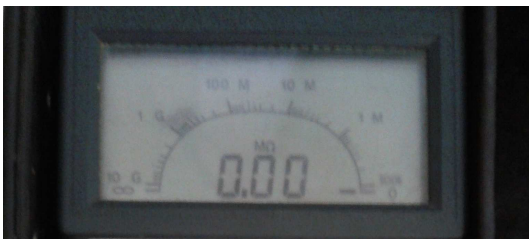
Obr. 8.09 Izolační stav žil a stínění
