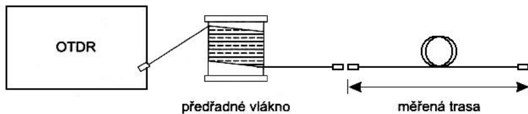
Obr. 5.08 Schéma zapojení OTDR [19]
