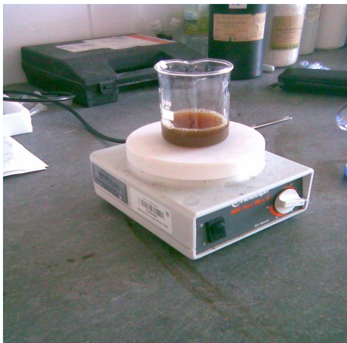
obrázek 9 : Příprava nanočástic stříbra na míchačce Heidolf MR Hei Mix S
