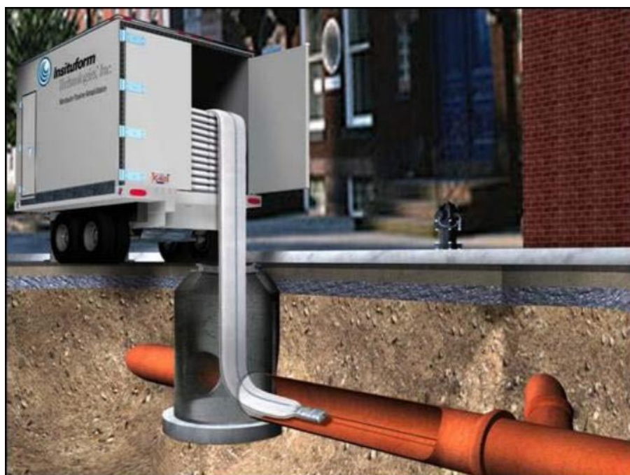
Obr. 36 Aplikace metody CIPP zatahováním [28]
