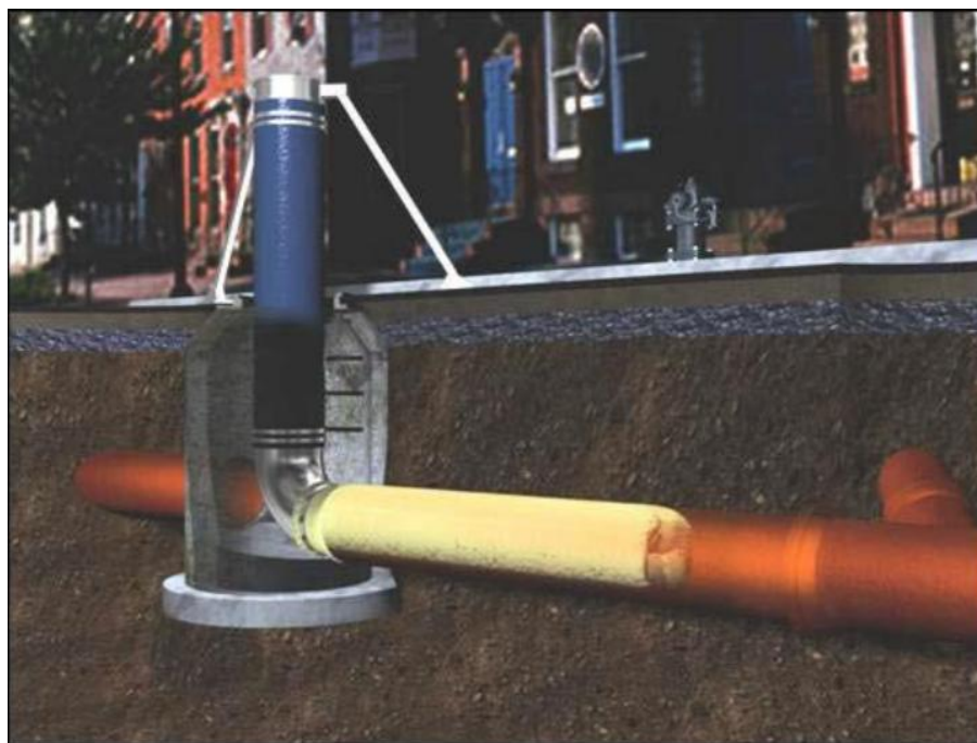
Obr. 35 Inverzní aplikace metody CIPP [28]
