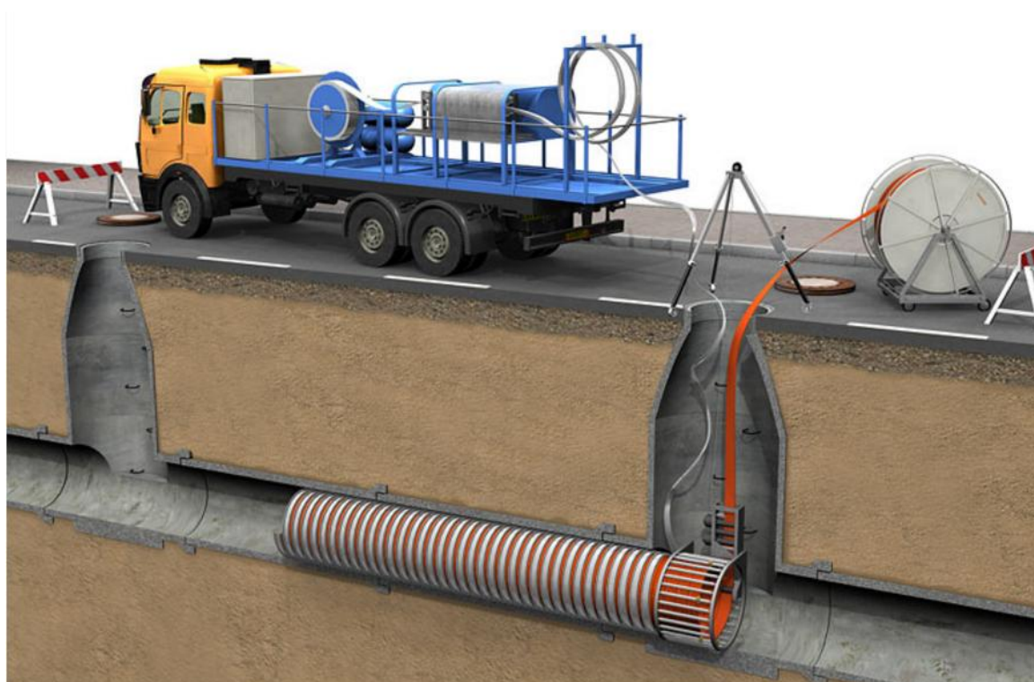
Obr. 33 Schéma zavádění navíjených trub kruhového průřezu statickým zařízením. [45]
