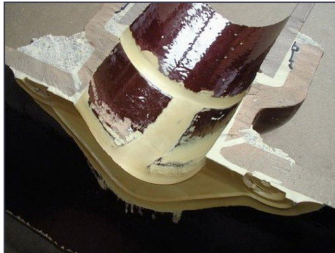
Obr. 20 Řez potrubí opraveným metodou Inject. [33]
