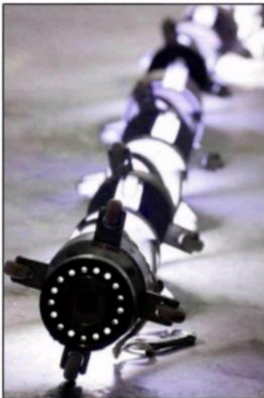
Obr. 37 Vytvrzovací UV lampa s kamerou [28]
