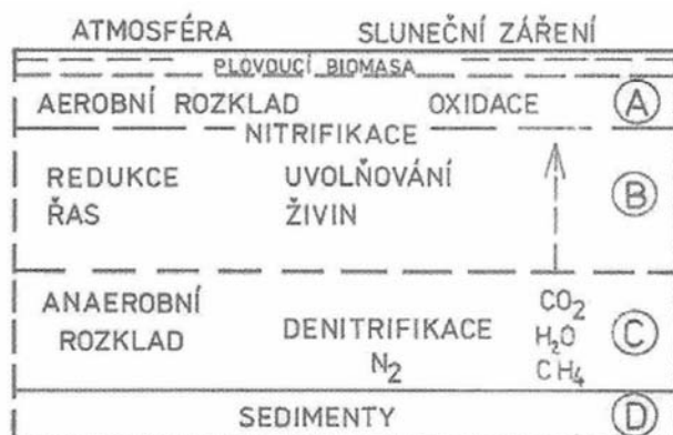
Obr. č. 11: Schematické znázornění čistících procesů v nádržích s plovoucí biomasou (Šálek, Tlapák, 2006)
