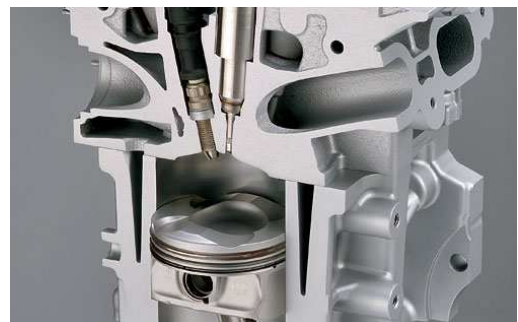
Obr. 1.12: Piest s časťou spaľovacieho priestoru vytvoreného v dne piesta (priame vstrekovanie) a vybraniami pre ventily (BMW 335i) [5]
