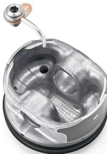
Obr. 1.15: Piest s vnútorným chladením [13]
