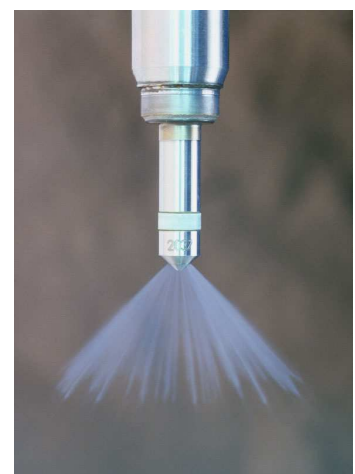
Obr. 1.2: kónický lúč vytvorený vstrekovacou tryskou [10]
