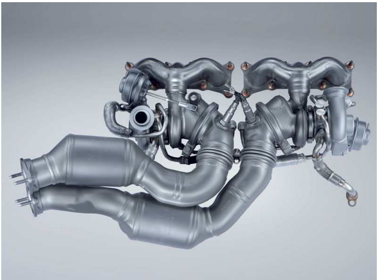
Obr. 1.9: Preplňovanie dvojicou turbodúchadiel tzv. Twin-turbo [5]
