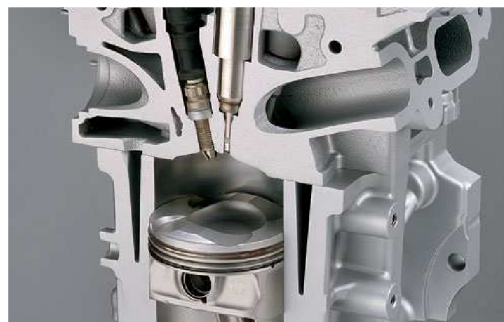
Obr. 1.12: Piest s časťou spaľovacieho priestoru vytvoreného v dne piesta (priame vstrekovanie) a vybraniami pre ventily (BMW 335i) [5]
