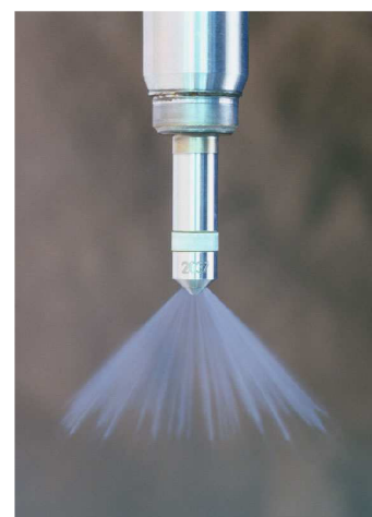
Obr. 1.2: kónický lúč vytvorený vstrekovacou tryskou [10]
