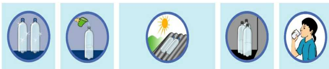
Obr. 2.13 Znárodné principu solární dezinfekce [42]
