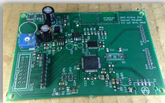
Obrázek 4.1.2.2.: Téměř zapájená deska pl.s.
