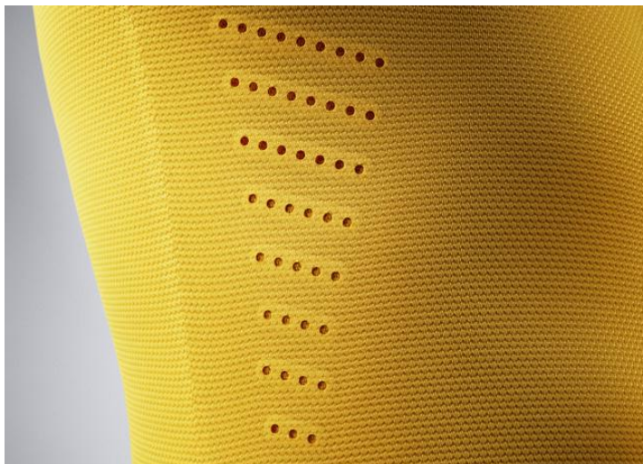
Obrázek 4: Lokální ochlazování pomocí laserem vyřezaných otvorů, zdroj: [13]
