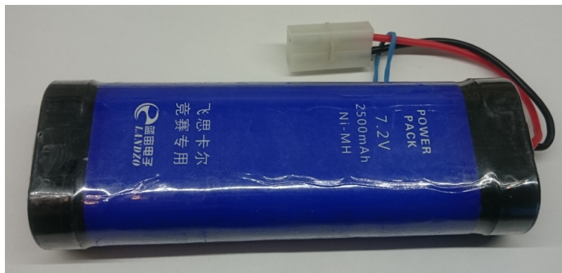
Obrázek 3.2: Baterie modelu NXP Cup Alamak. Jedná se o 6-ti článkový Ni-MH akumulátor s kapacitou 2500 mAh a jmenovitým napětím 7,2 V.
