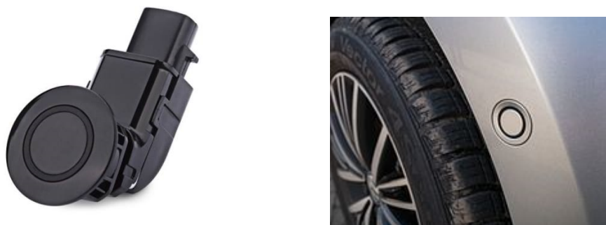
Obrázek 2.4: Ultrazvukový senzor. Samostatný modul (vlevo), senzor zabudovaný v nárazníku (vpravo).
