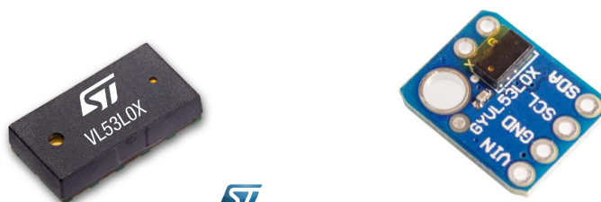
Obrázek 3.8: Laserový senzor vzdálenosti VL53L0X. Samostatný modul (vlevo), modul osazený na desce (vpravo).
