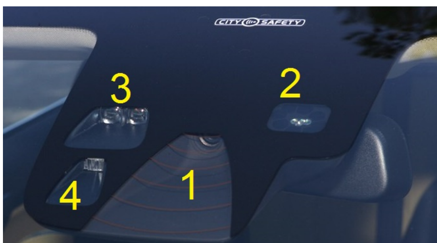
Obrázek 2.3: Kamerový modul City Safety. 1. běžná kamera, 2. dešťový senzor, 3. přijímač LIDAR, 4. vysílač LIDAR.
