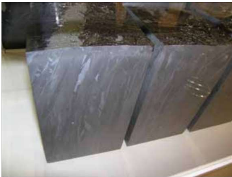
Obr. 11: Odlitý polykrystalický křemík
