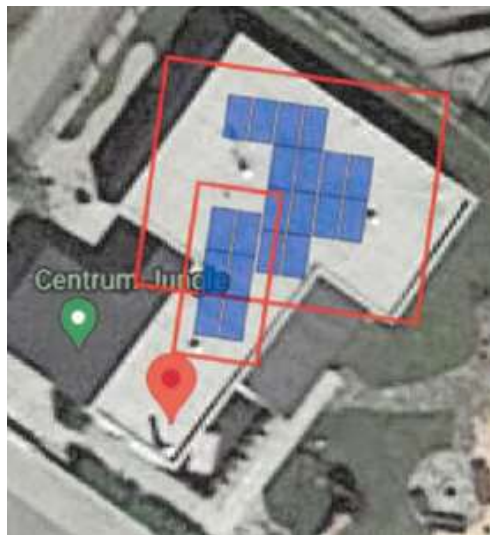
Obr. 17: Návrh umístění panelů
