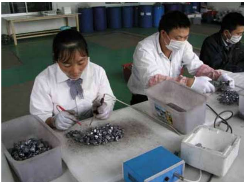
Obr. 7: Testování hrudek čistého křemíku Jiaxing (Čína)
