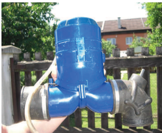
Obr. 7 Membránový sací ventil Roevac
