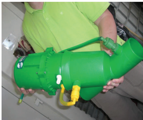
Obr. 78 Třícoulový ventil – Flovac
