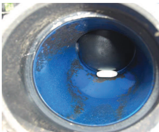
Obr. 8 Membránový sací ventil Roevac s uzavřenou membránou
