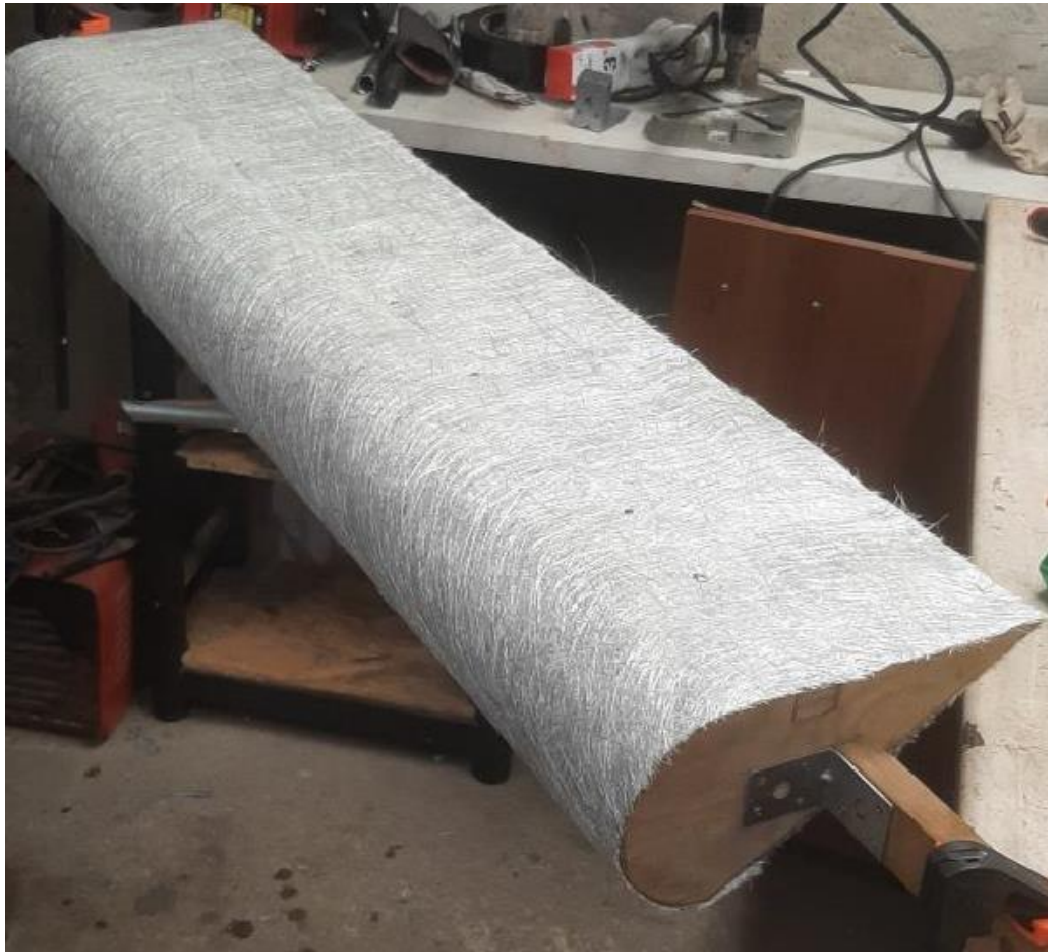
Obrázek 8-7 Lopatka pokrytá skelnou rohoží připravená k laminaci epoxidovou pryskyřicí
