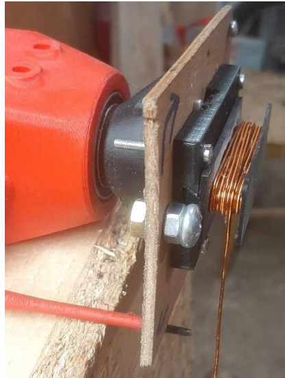
Obrázek 9-6 Ruční navíjení cívek
