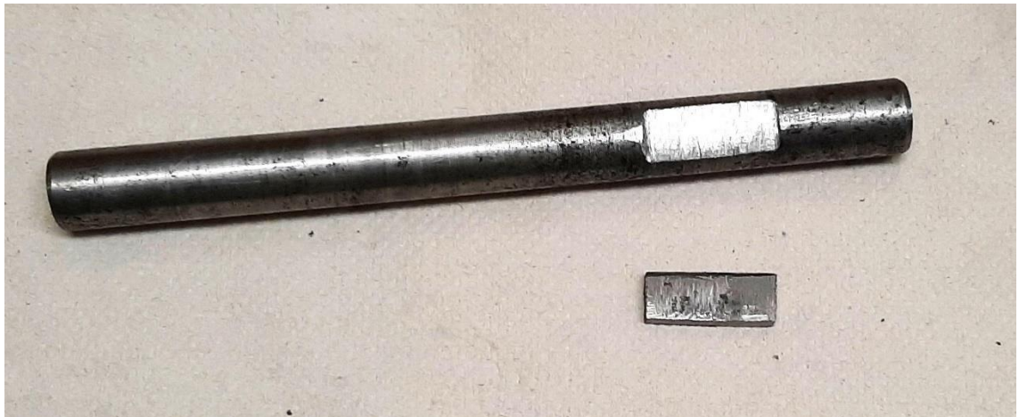
Obrázek 9-4 Osa generátoru s pojistným kolíkem
