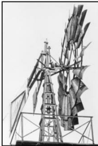
Obrázek 4-3 Větrné "westernové" kolo [17]
