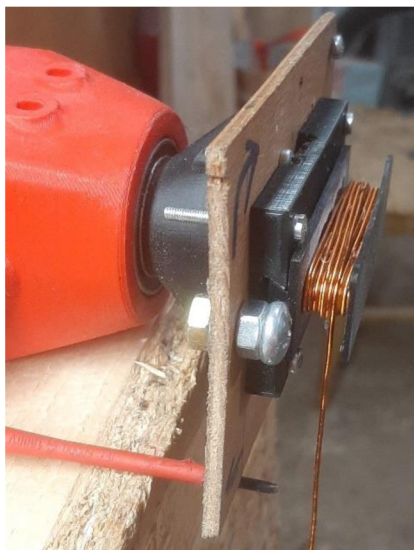
Obrázek 9-6 Ruční navíjení cívek
