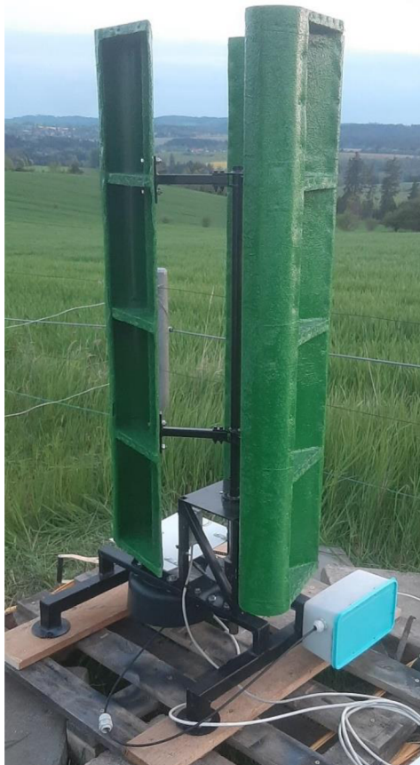
Obrázek 11-2 Ukázka z testování větrné turbíny v reálném provozu
