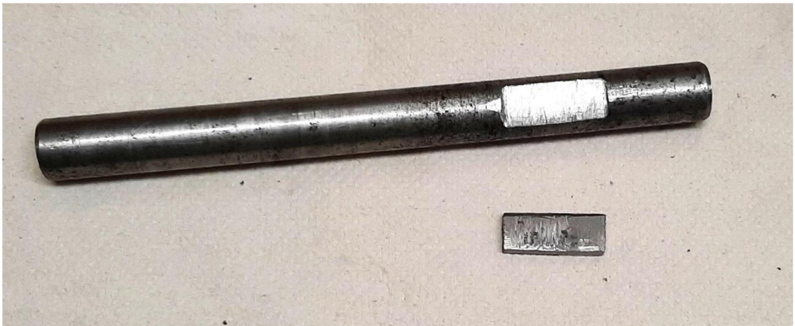
Obrázek 9-4 Osa generátoru s pojistným kolíkem
