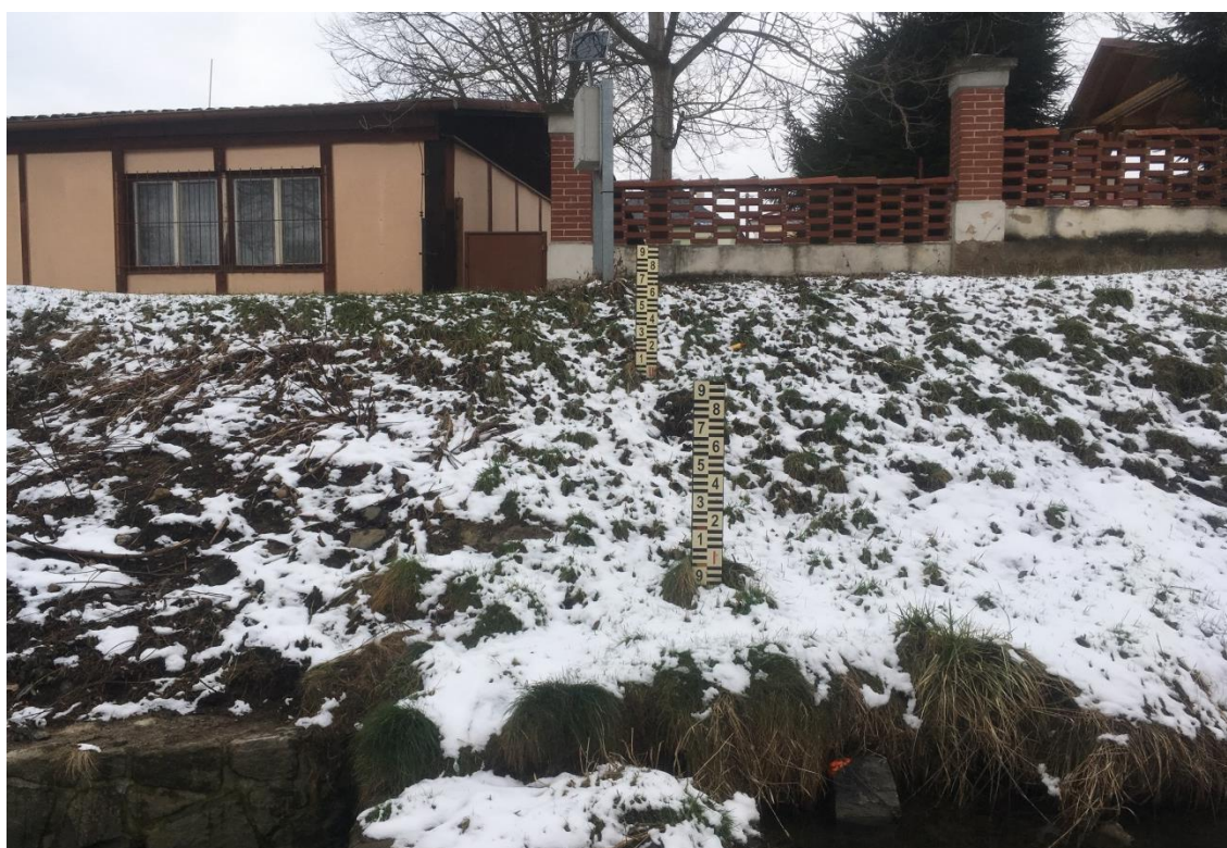
Obr. 3.11 – Hlásný profil kat. C, Klatovy - Drnový potok (vybavení: vodočetná lať)
