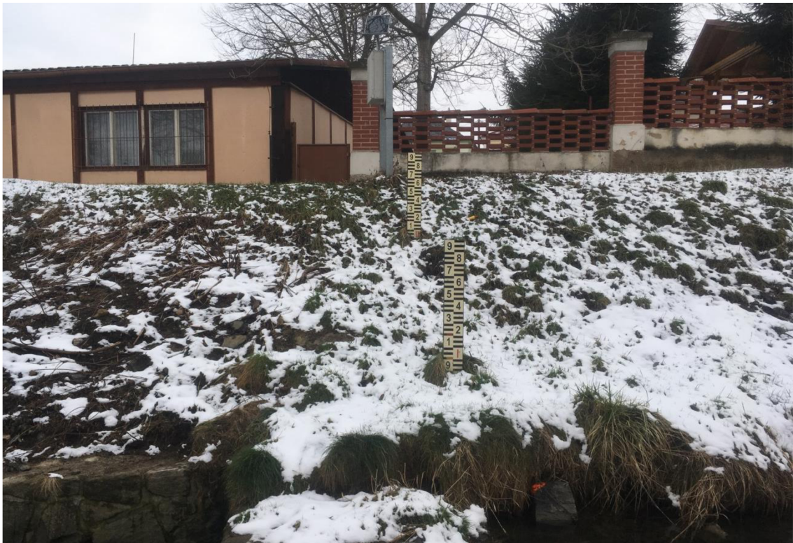
Obr. 3.11 – Hlásný profil kat. C, Klatovy - Drnový potok (vybavení: vodočetná lať)
