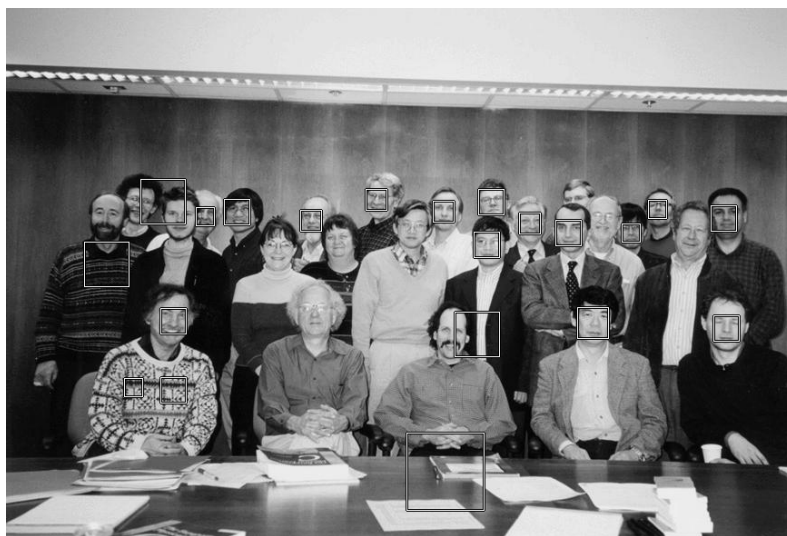
Obrázek 8.8: Po odstranění nepřekrývajících se detekcí
