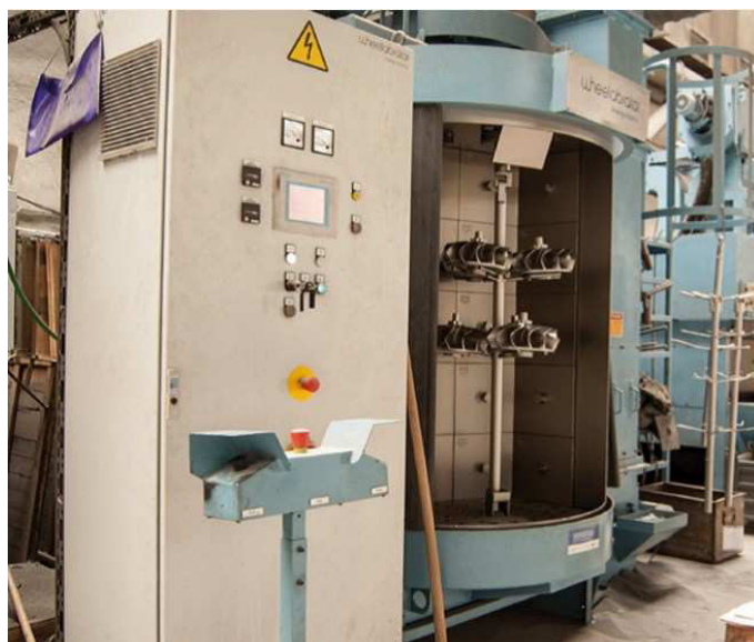
Obr. 21 Dvoukomorový závěsný tryskač [23]
