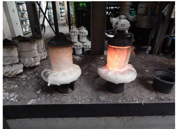
Obr. 28 Skořepinové formy na licím poli [26]
