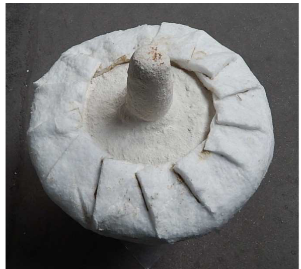
Obr. 26 Způsob izolace skořepiny (horní pohled) [26]
