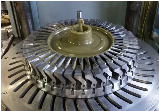
Obr. 23 Voskový model v matečné formě [26]
