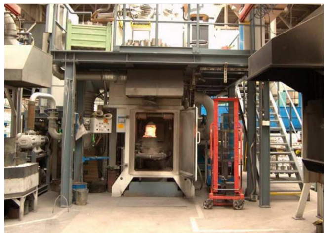
Obr. 19 Vakuová dvoukomorová indukční pec [23]
