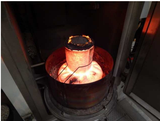
Obr. 27 Skořepinová forma po aplikaci exotermického zásypu [26]
