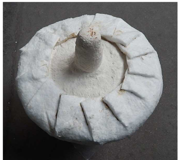
Obr. 26 Způsob izolace skořepiny (horní pohled) [26]
