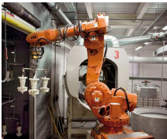
Obr. 16 Robot vodní obalovací linky [23]
