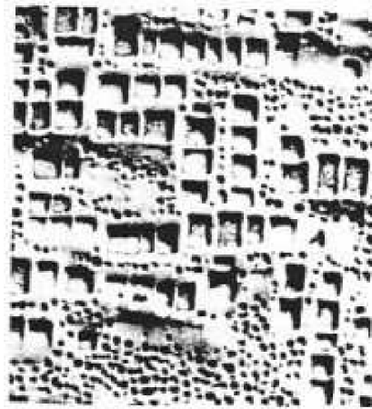
Obr. 5 Bimodální struktura s vyšším obsahem fáze \gamma' [11]
