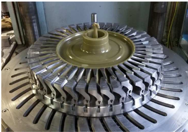
Obr. 23 Voskový model v matečné formě [26]
