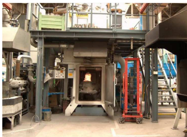
Obr. 19 Vakuová dvoukomorová indukční pec [23]
