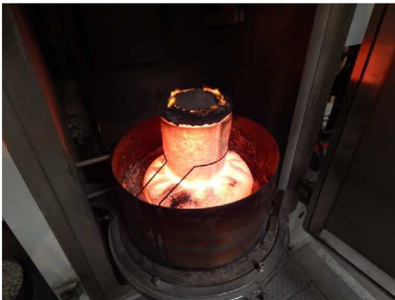
Obr. 27 Skořepinová forma po aplikaci exotermického zásypu [26]
