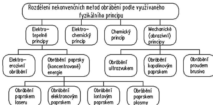
Obr. 3 Rozdělení nekonvenčních metod obrábění. 6
