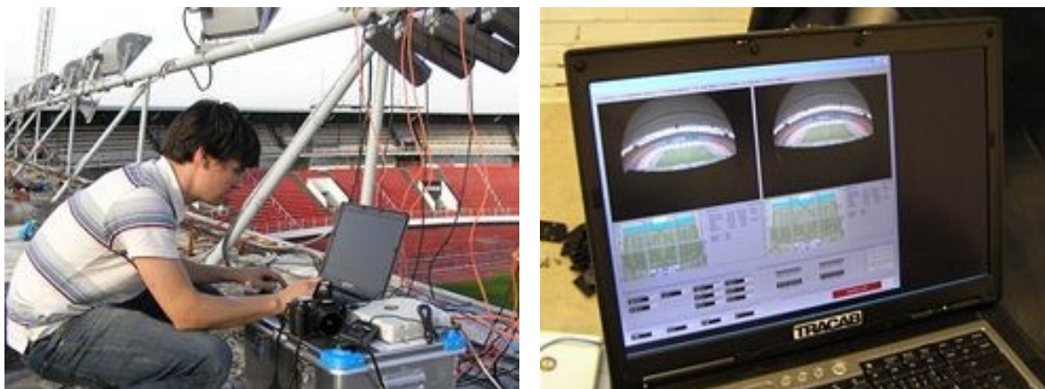
Obrázek 11. Instalace a kalibrace systému Tracab ( http://technet.idnes.cz/jak-funguje-system-ktery-vi-o-fotbalistech-vsechno-poprve-v-cr-p7p-/tec_reportaze.aspx?c=A061002_161541_tec_reportaze_kuz )
