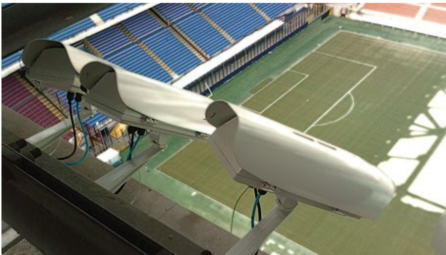
Obrázek 14. Monitorovací zařízení systému Amisco
