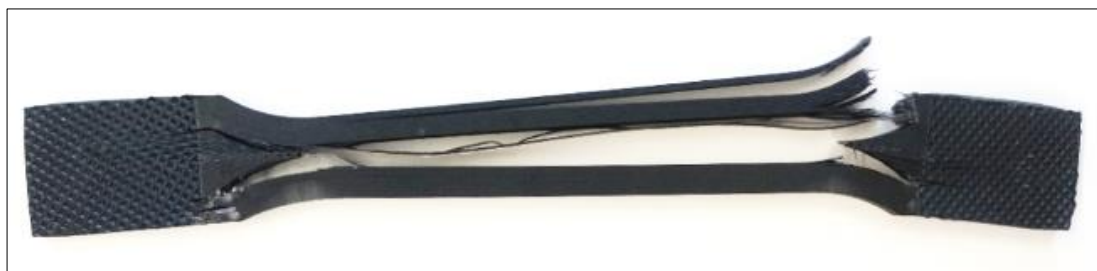
Obr. 48 - Předčasně porušené těleso 0,127 (K) z materiálu PC/ABS
