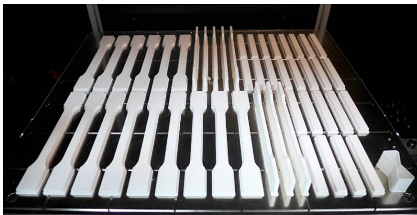
Obr. 31 – Vytisknutá tělesa z materiálu ABS - M30 před vyjmutím z pracovního prostoru tiskárny
