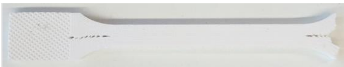
Obr. 44 - Ukázka předčasně porušeného tělesa šarže 0,330 (K) z materiálu ABS - M30
