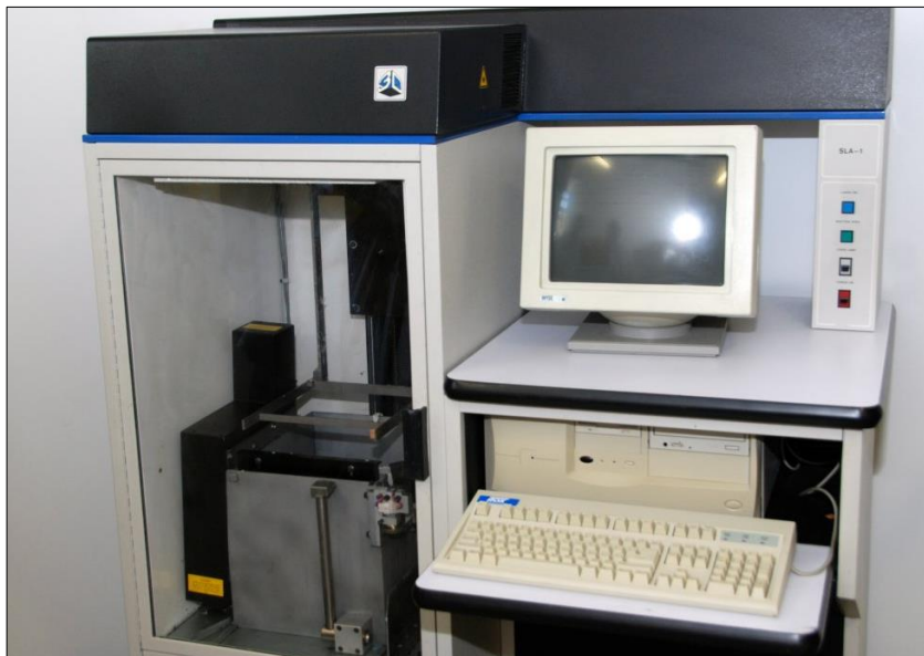
Obr. 7 - První 3D tiskárna SLA-1 od firmy 3D Systems [19]
