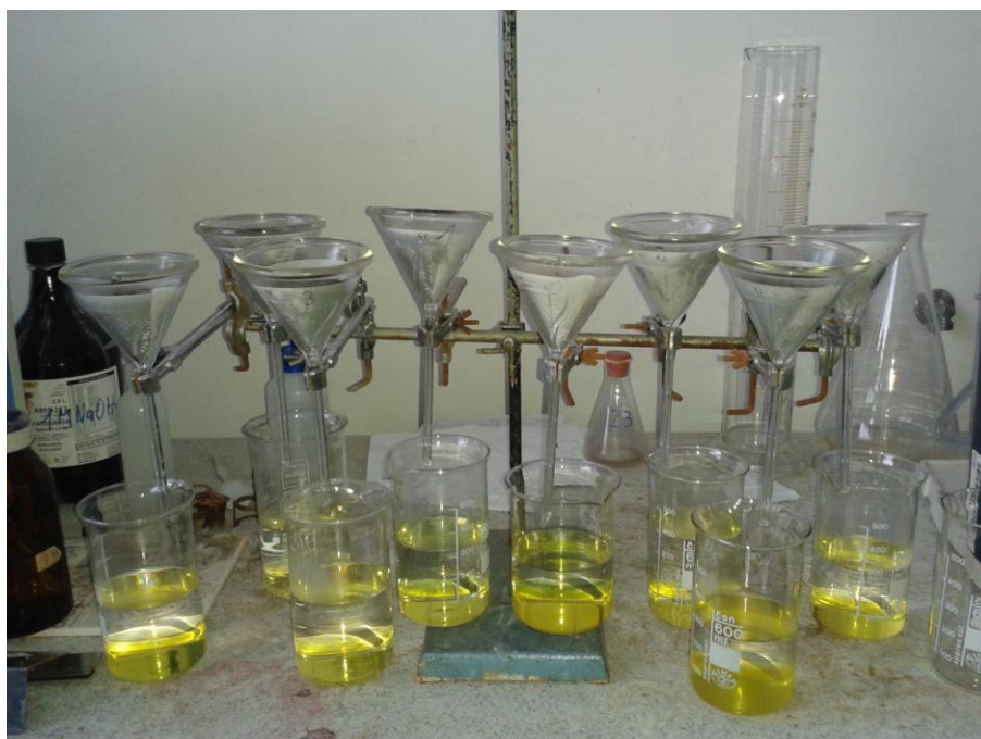
Obr. 14: Stojan k profiltrování vzorků
