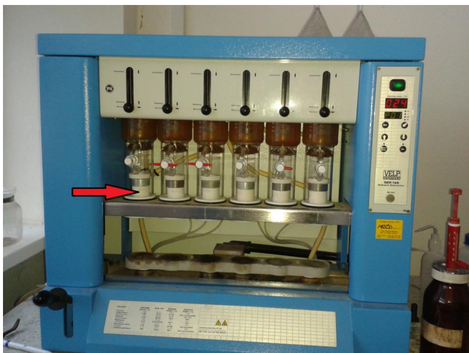
Obr. 12: Příklad Solvent Extraktor, šipka na obrázku ukazuje na vložené extrakční patrony s naváženým vzorkem
