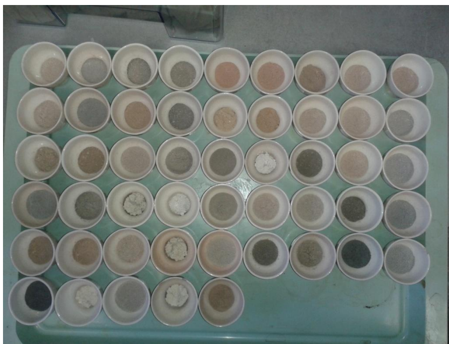
Obr. 13: Keramické misky se spáleným materiálem pro určení obsahu popelovin
