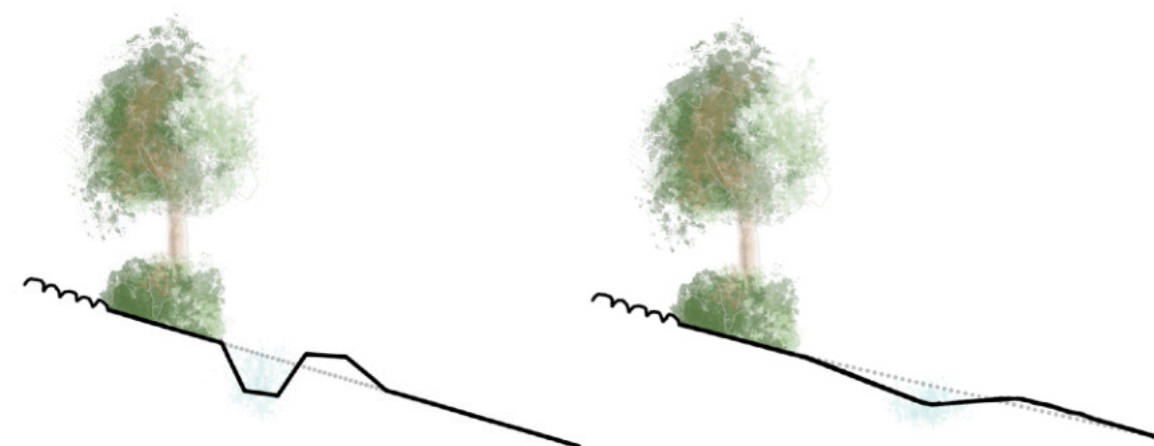
Obr. č. 4: Záchytný příkop a zatravněný průleh (zdroj: autor)
