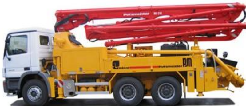
Obrázek 43 3.1.2.2 Mobilní čerpadlo betonu Putzmeister BSF 28-4.11 H
