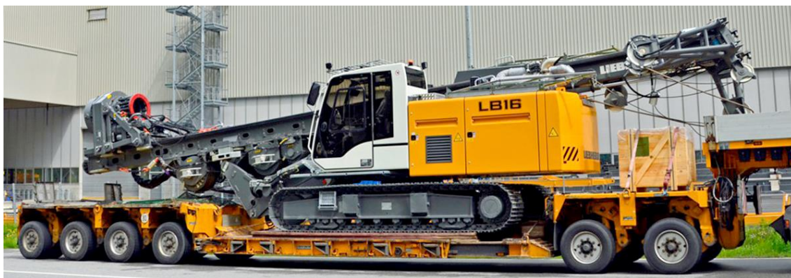
Obrázek 22 Přeprava vrtné soupravy Liebherr LB16-180
