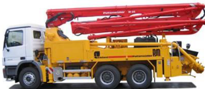
Obrázek 43 3.1.2.2 Mobilní čerpadlo betonu Putzmeister BSF 28-4.11 H
