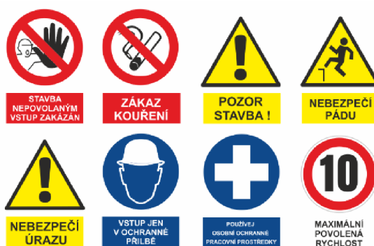
Obrázek 53 Bezpečnostní značky pro označení stavby
