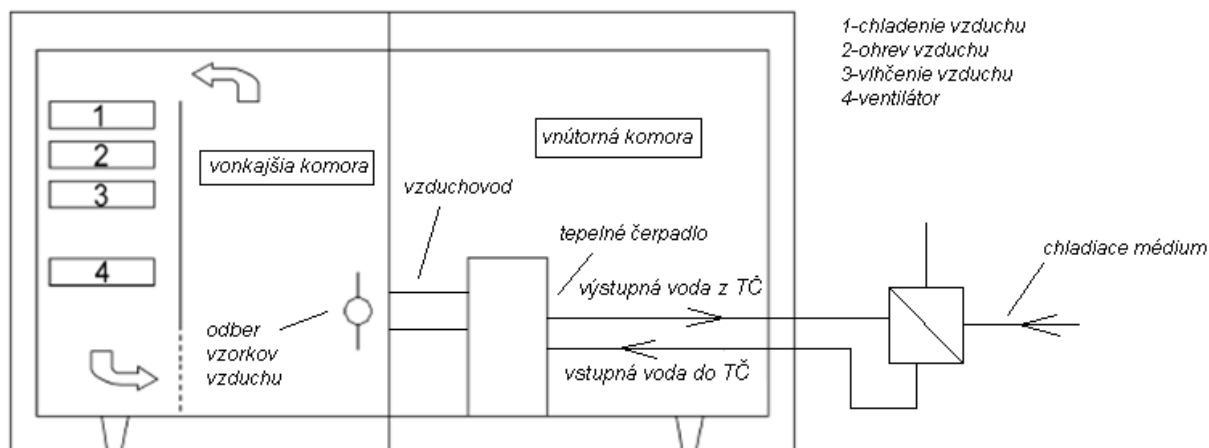
Obr. 2.1 Skúšobňa TČ typu vzduch-voda [6].
