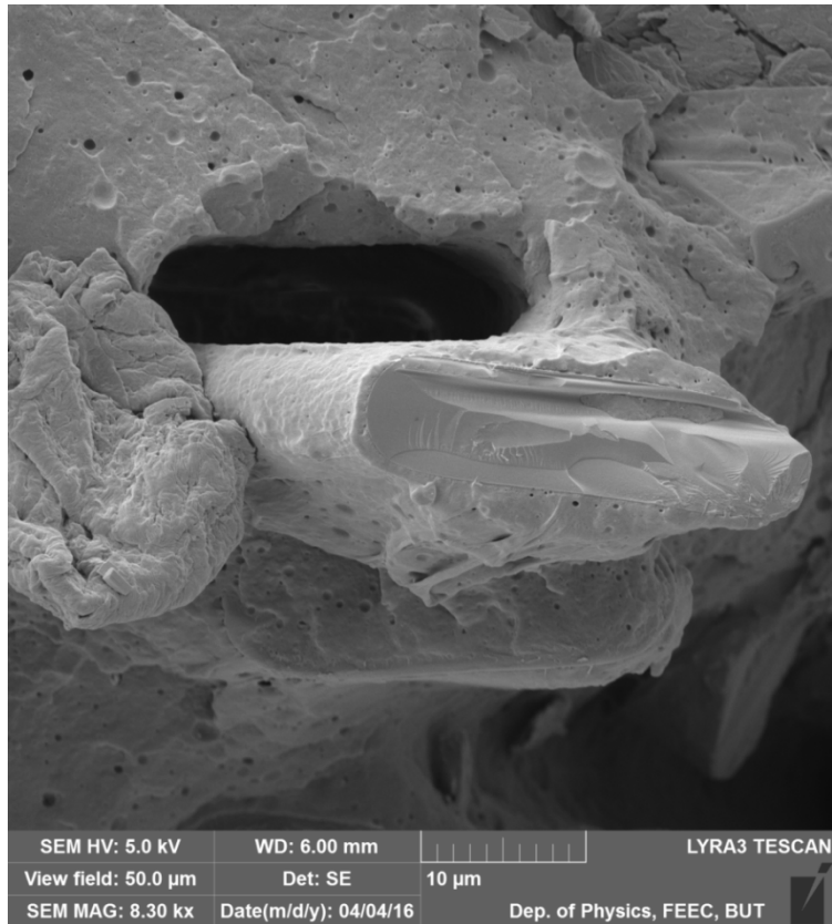
Obr. 20 Snímek lomové plochy neozářeného PA/GF zachycující adhezi matrice ke skelným vláknům a otvor po vytaženém skleněném vlákně
