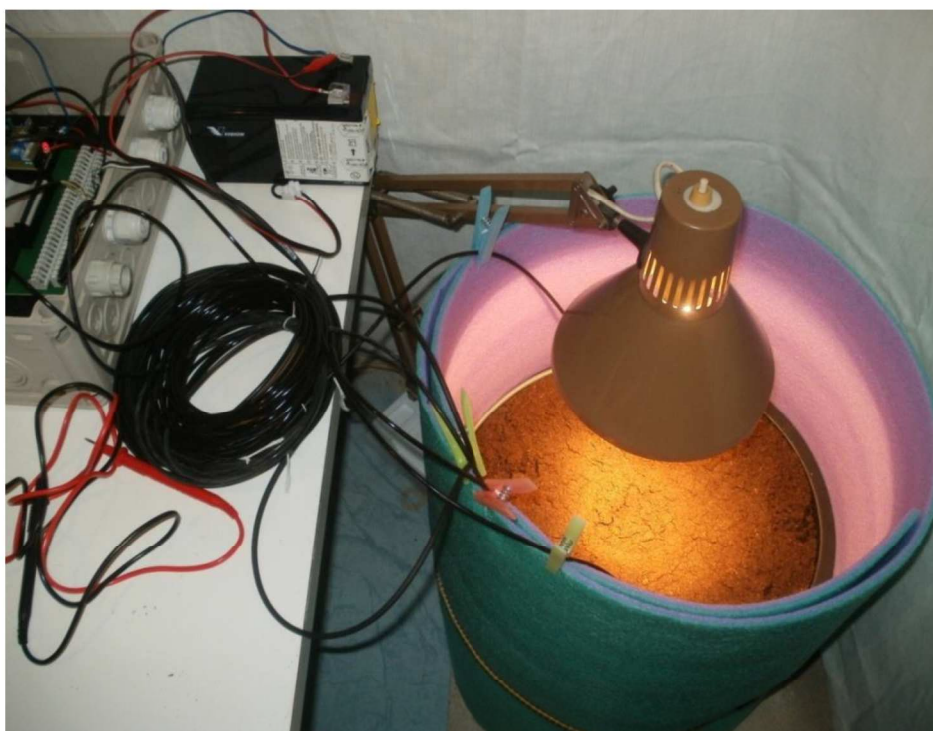
Obr. 6 Detail dvacetičtyřhodinového ohřevu substrátu rašeliny lampou s čirou parabolickou žárovkou 60W.
