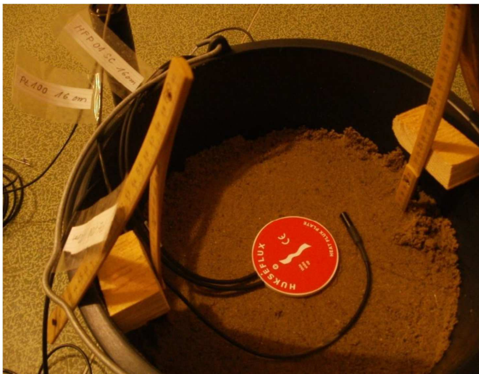
Obr. 3 S čidlem Hukseflux HFP-01SC bylo umístěno do substrátu ve stejné úrovni 16 cm čidlo PT100 pro kontrolu správnosti měření.
