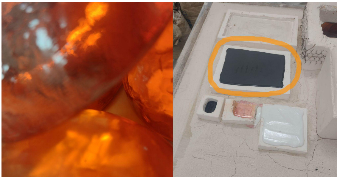
Obrázek 47 Rozdíl v barvě skla před a po utavení
