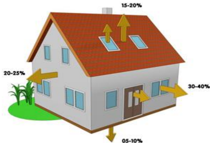
Obr. č. 1 – Procentuální podíl tepelné ztráty obálkou budovy [9]
