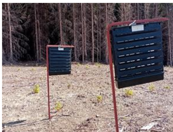
Obr.12: Instalovaná dvojice feromonových lapačů s různými směsí feromonů a anti-atraktantů v porostu 328B2. (Zdroj: vlastní foto, 2020 )
