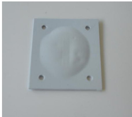
Obr. 25: Puchýřek vytvořený na povrchu vzorku.
