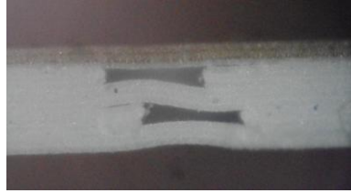
Obr. 24: Příčný řez znázorňující nepřesné sesouhlasení jednotlivých kanálků.
