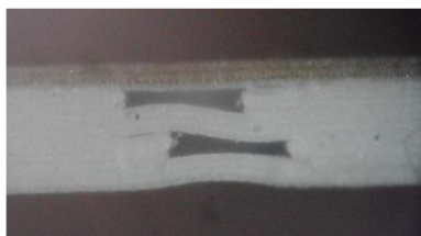
Obr. 24: Příčný řez znázorňující nepřesné sesouhlasení jednotlivých kanálků.
