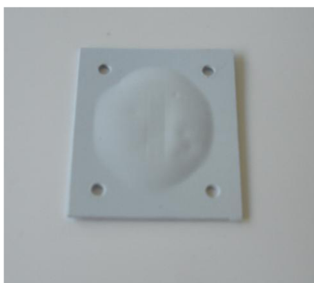
Obr. 25: Puchýřek vytvořený na povrchu vzorku.
