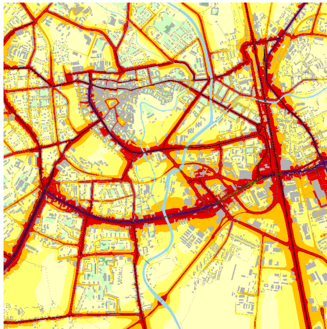
Obr. 20 Návrh znázornění výřezu strategické hlukové mapy aglomerace Olomouc pro projekční model (upraveno z MZČR, 2010).
