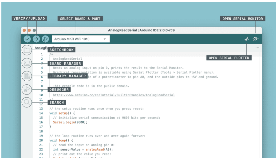
Obrázek 7 Arduino integrované vývojové prostředí, Zdroj: https://docs.arduino.cc/software/ide-v2/tutorials/getting-started-ide-v2/
