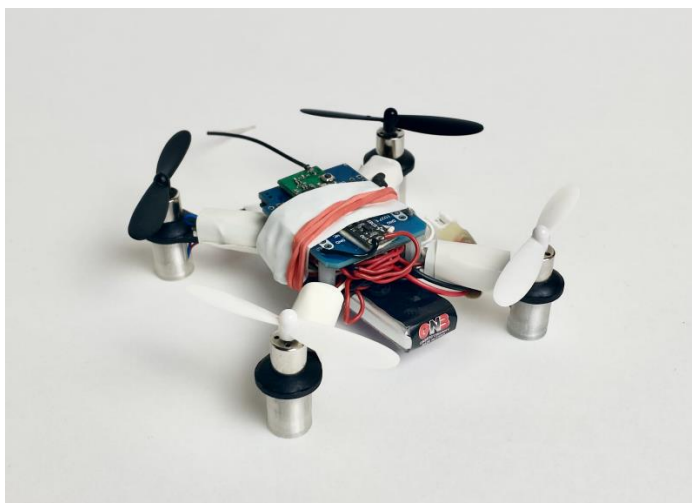
Obrázek 6 Kvadroptéra na bázi Arduina, Zdroj: https://projecthub.arduino.cc/okalachev/flix-58fe43
