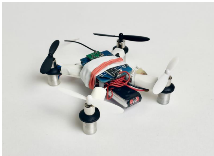
Obrázek 6 Kvadroptéra na bázi Arduina, Zdroj: https://projecthub.arduino.cc/okalachev/flix-58fe43
