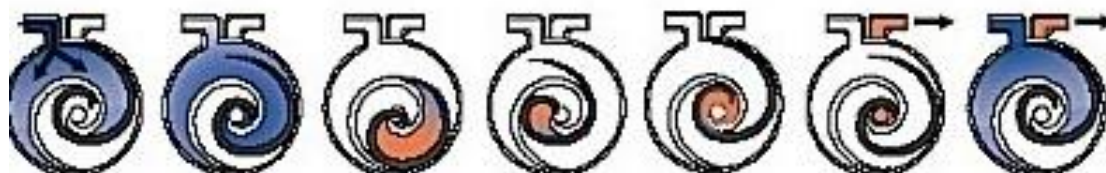
Obr.4.19 Průběh dějů ve spirálovém kompresoru [18]
