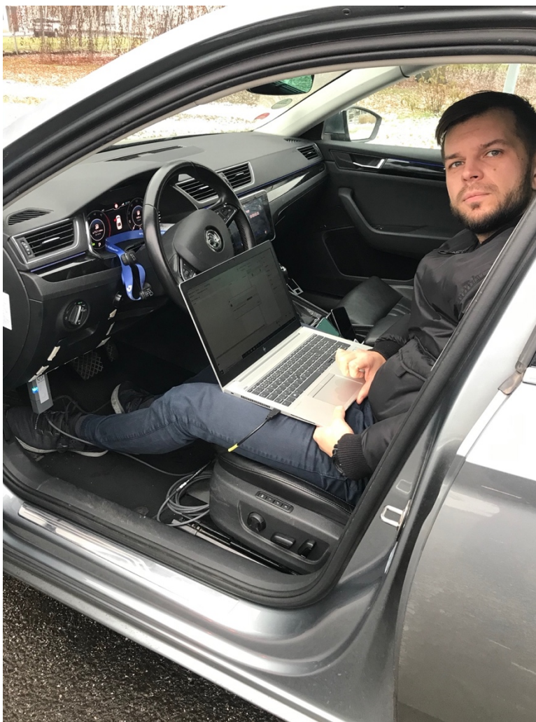
Příloha č.1. Čtení dat z jednotek ve vozidle pomoci diagnostické hlavy a programu ODIS na vozidle Superb III.
