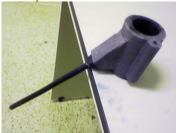
Foto 17: Retorta pro nízkotepeľnou karbonizační zkoušku dle ČSN ISO 647 (441371)
