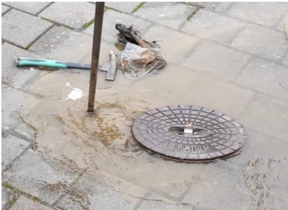
Obrázek 3.18 Zkouška otevření hydrantu
