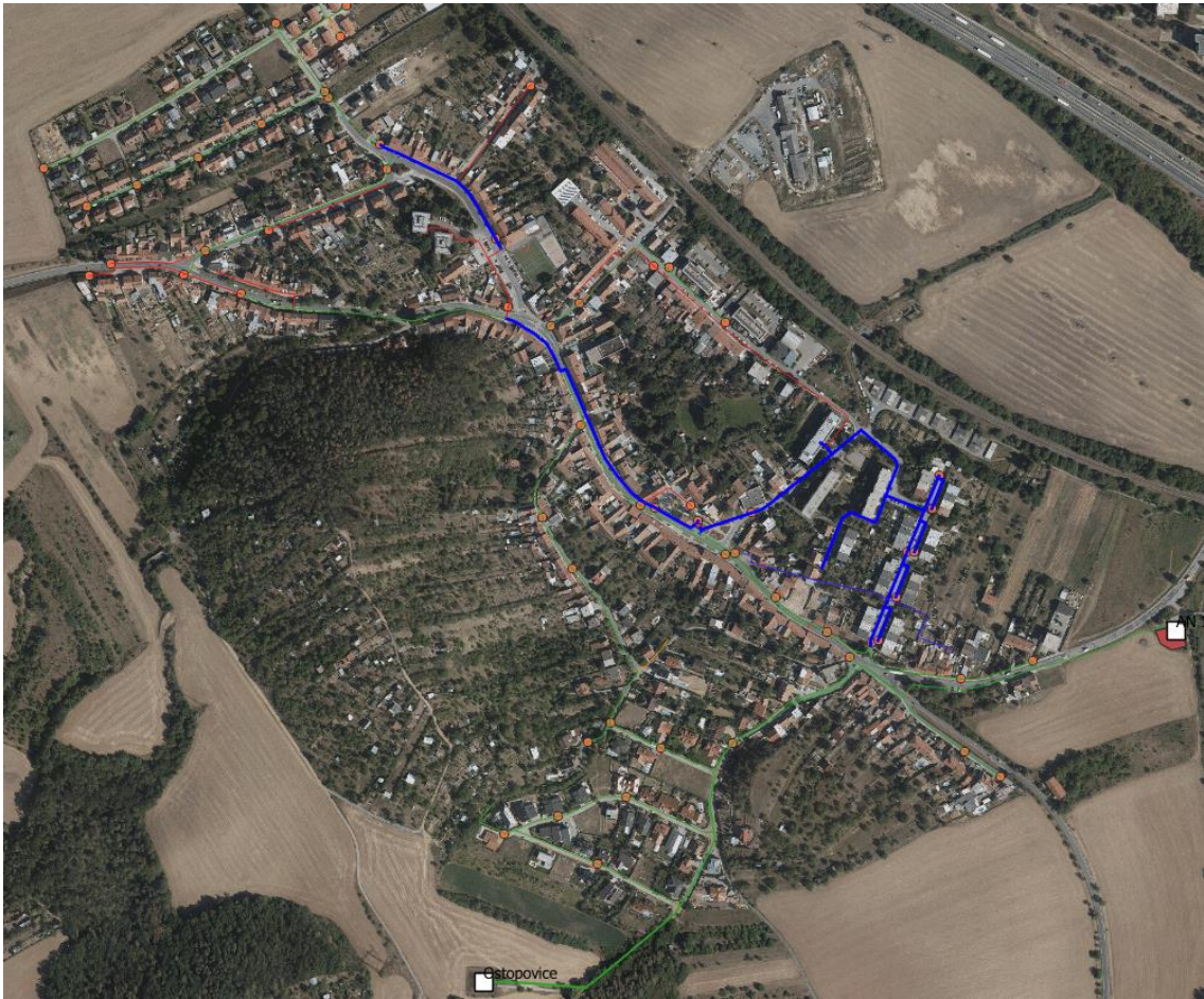
Obrázek 3.38 Vodovodní síť obce Ostopovice (tmavě modrá = potrubí z šedé litiny)
