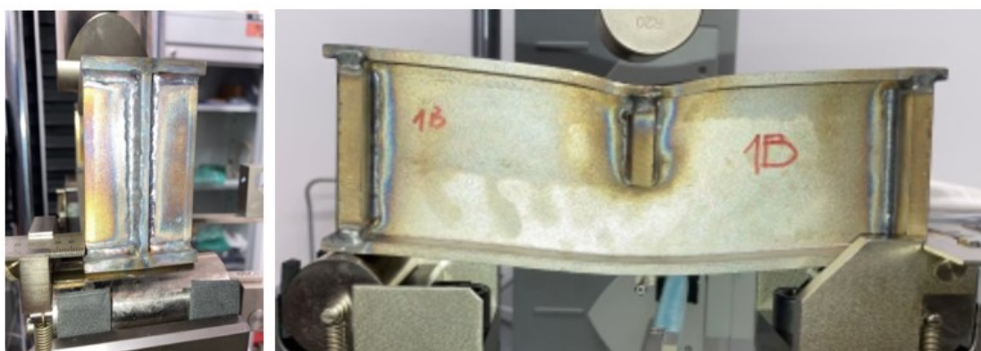
Obr. 1.22: Deformace vyztuženého nosníku na konci experimentu
