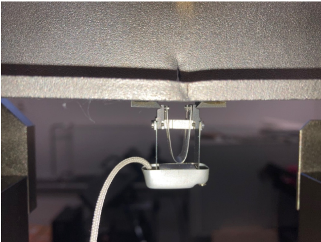
Obr. 1.26: Detail měřiče otevření trhliny
